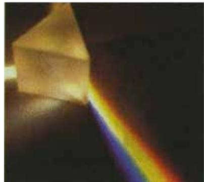
Descomposición espectral de la luz al atravesar un prisma de vidrio.
